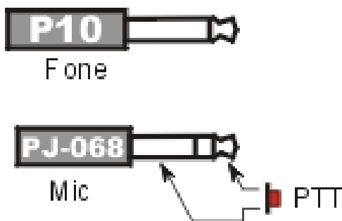
PLUGUES DO INTERCOM PARA CONEXÃO NO RÁDIO VHF
