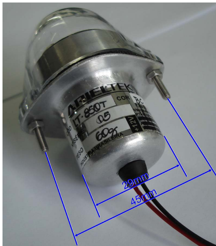
Figura 8 – Dimensões da lanterna de navegação de cauda
