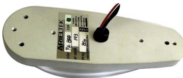
Figura 2 – vista inferior da lanterna de ponta de asa
